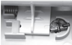
释放凸轮 凸轮旋转 90°，可快速释放或锁定容器单元
