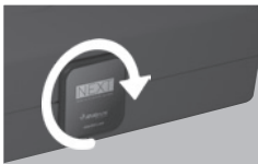
可定位 LCD 安装在机器上的 LCD 面板可以安装在任何位置，并且可以旋转，以始终保持最佳视野。
